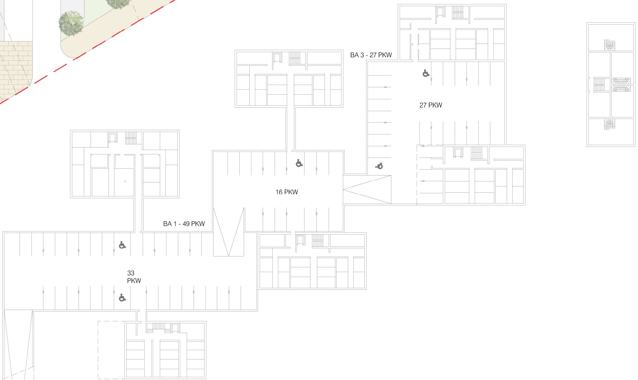
TIEFGARAGE VARIANTE 1 - 1 Ein-/Ausfahrt M 1:500
