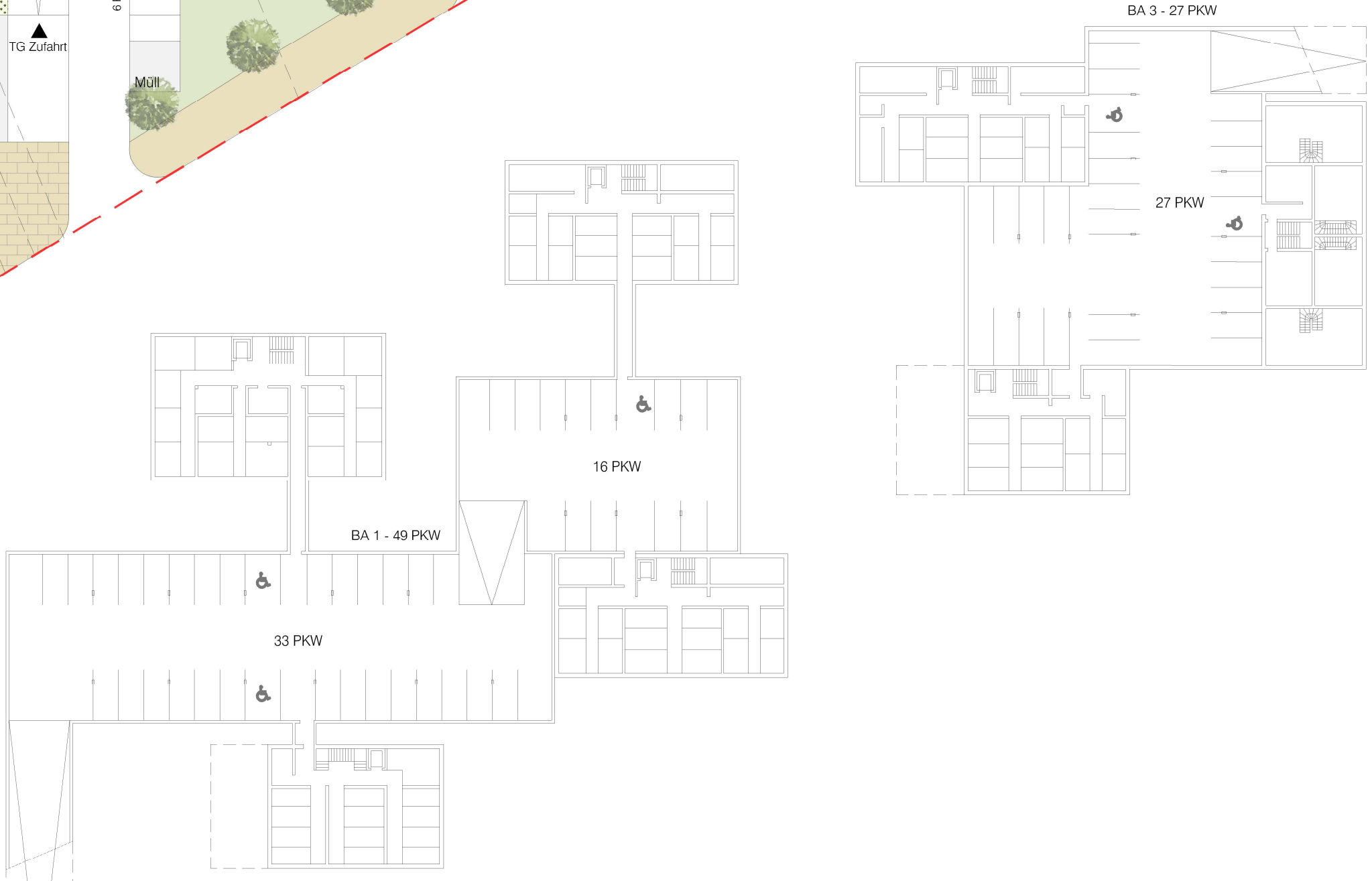
TIEFGARAGE VARIANTE 2 - 2 Ein-/Ausfahrten M 1:500
